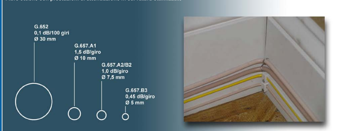
Fibre ottiche con prestazioni di attenuazione in curvatura ottimizzate
